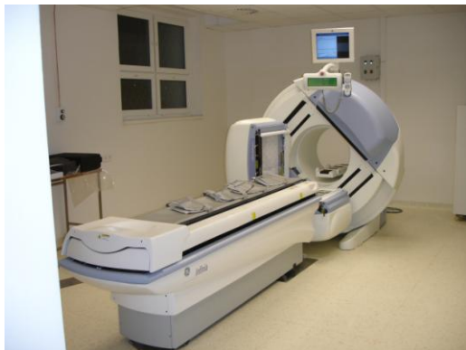
Nová hybridní gamakamera (SPECT/CT) pro kombinované vyšetření pomocí radionuklidů a rentgenu v novém prostoru pavilonu C. Foto: Šot
